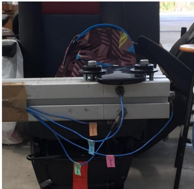
*Figura 21 Detalle de la instalación de los acelerómetros sobre el brazo vibrador. El de realimentación lleva la etiqueta verde y los otros corresponden a los ejes x (rosa), y (azul) y z (naranja)*
