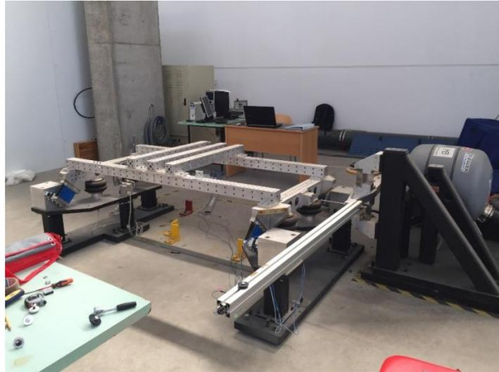
Figura 17 Banco de Squeak & Rattle utilizado en los experimentos
