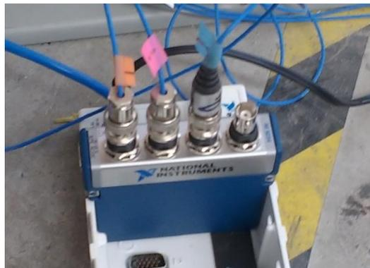
*Figura 25 Conexión de los acelerómetros con el módulo del DAQ*
