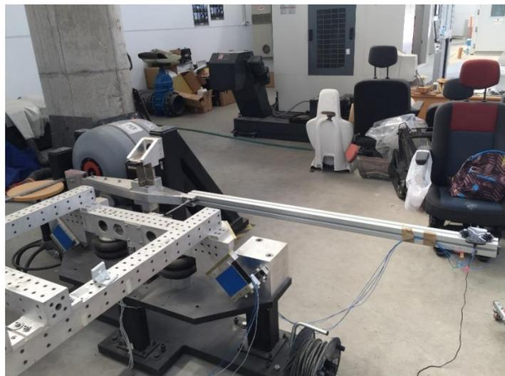
Figura 18 Excitador SILVER y brazo vibrador con el teléfono de pruebas y los acelerómetros instalados
