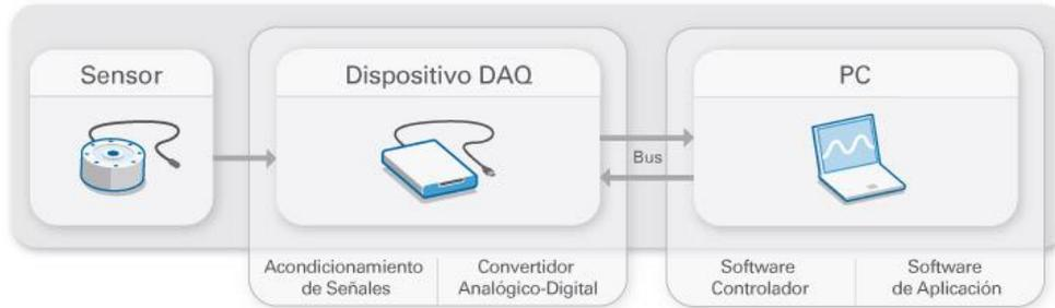
Figura 22 Esquema de un sistema de adquisición de datos
