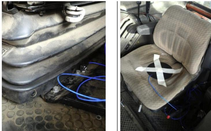
Figura 10 Posiciones de los acelerómetros en el anclaje del asiento (izquierda), y sobre el asiento (derecha)
