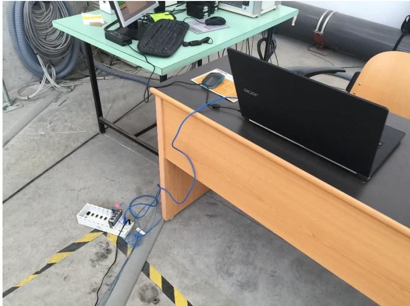
Figura 23 Sistema DAQ montado para las pruebas. Se puede ver la conexión de los acelerómetros con el dispositivo DAQ, y la conexión de este con el PC
