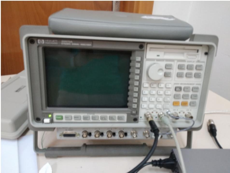
Figura 1.9: Analizador de señal.
