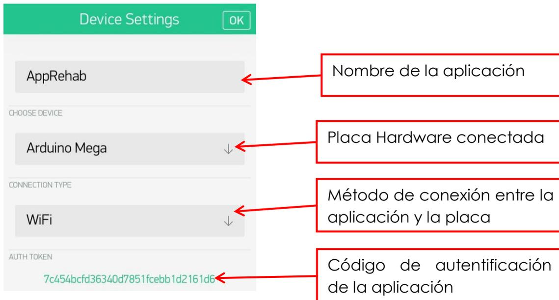
Figura 48. Ajustes del dispositivo en la aplicación Blynk.
