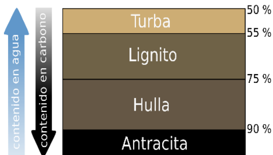
Figura 10. Diagrama de representación de los diferentes tipos de carbón según su porcentaje de Carbono y de agua. Fuente: Google imágenes.
