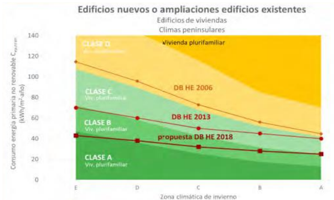
Figura 118. Gráfico de la evolución en las exigencias del código técnico a través de sus sucesivas versiones, relacionadas con la clasificación establecida por el sistema de certificación energética actual. Fuente: Google imágenes.
