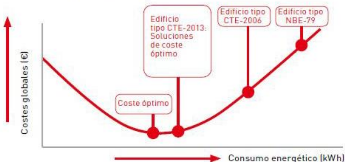
Figura 63. Gráfico de curva de costes de un edificio basado en el CTE 2013. Fuente: www.interempresas.net/Construccion/Articulos/142743-rockwool-recoge-los-principales-cambios-del-nuevo-cte-db-en-su-guia-que-cambia-partir-del-12-de-marzo.html .
