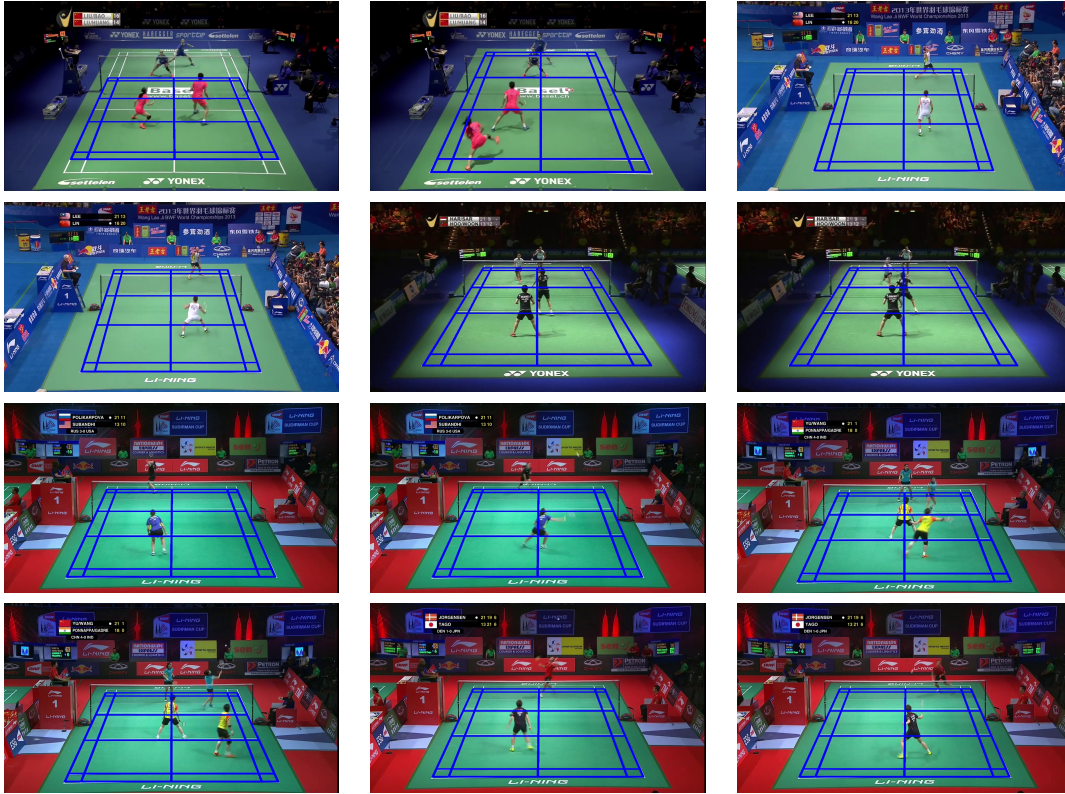
Figura 5.1: Resultados visuales para la detección de la pista: Hough + intersecciones + Homografía
