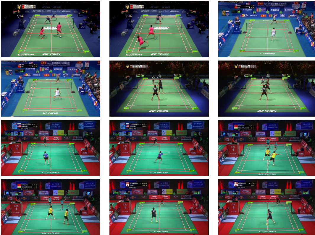
Figura 5.3: Resultados visuales para la detección de la pista: Faster R-CNN (corners) + Homografía
