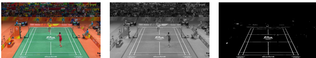
Figura 3.4: Umbralizado binario ( >200 ) para facilitar la detección de las líneas de la pista
