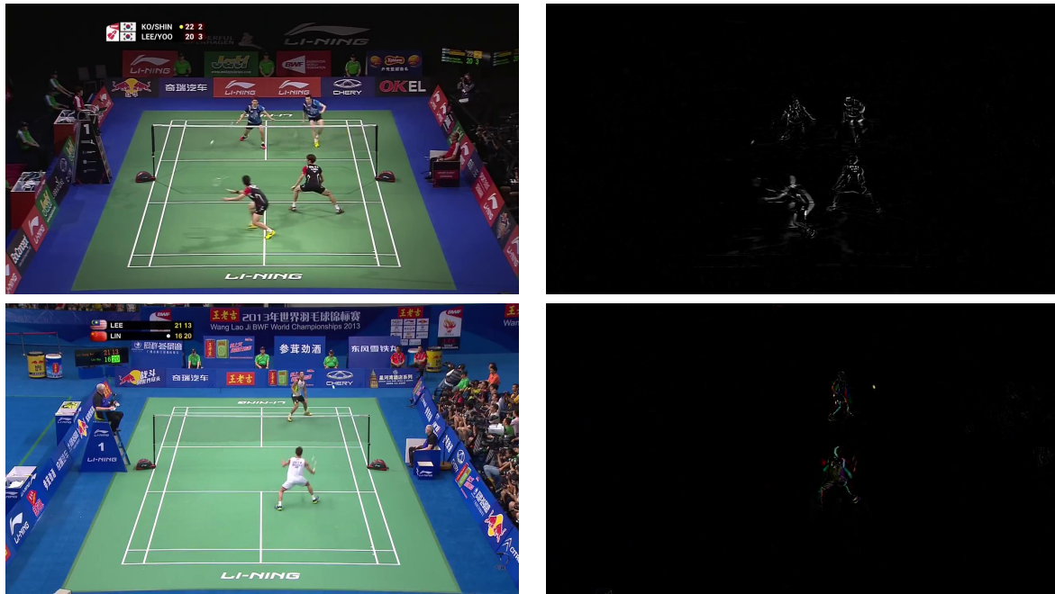
Figura 3.8: En la imagen se muestran ejemplos de las composiciones de cuatro y seis canales que usaremos para entrenar la detección del volante. Como puede apreciarse, en la imagen correspondiente a la resta de frames consecutivos es más fácil detectar la ubicación del volante.
