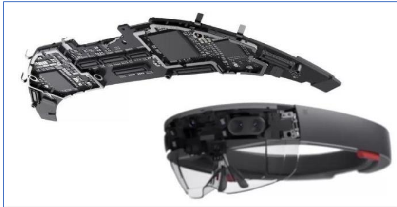
Figura 2.17. Tecnología interna dentro de unas gafas de Realidad mixta (Hololens).
