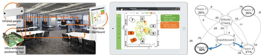
Fig. 10: Ejemplos de sensores de proximidad colocados para determinar la posición del alumnado en clase.
