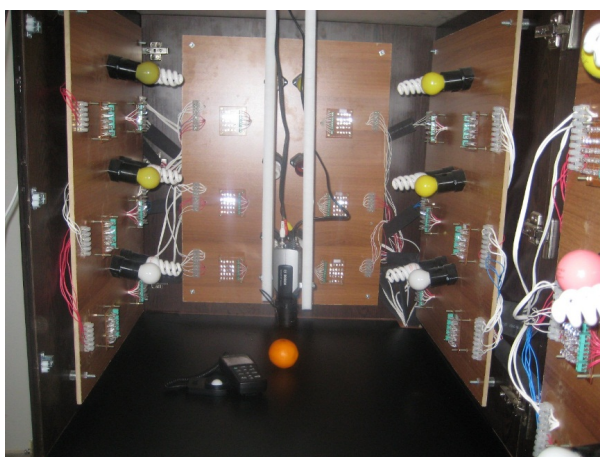
Figura 2.6: Entorno de captura de imágenes de cada una de las muestras de naranjas disponibles [21].
