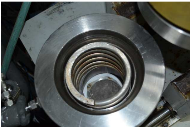
Fig. 12. Colocación de aro y resorte
