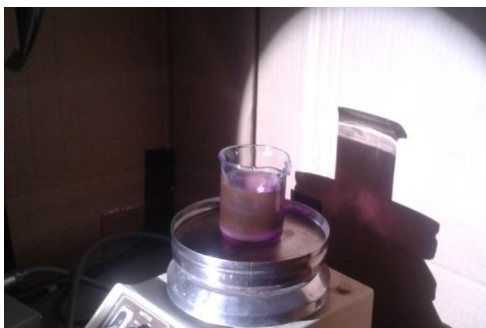
Figura 9. Remoción Rodamina-B en sala con total oscuridad con incidencia de luz procedente de una lámpara de xenón.
