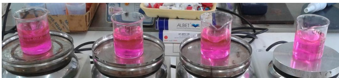
Figura 7. Disoluciones de Rodamina-B (4mg·L -1 ) a diferentes pH (2, 5, 8, 10).
