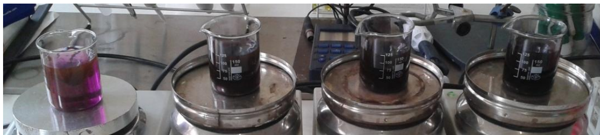
Figura 8. Remoción de Rodamina B variando la cantidad de carbón activado. De izquierda a derecha: 0.2, 0.4, 0.6 y 0.8g de carbón activo.
