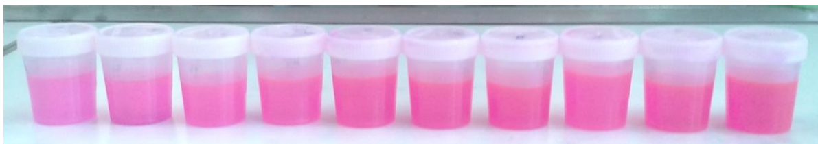
Figura 6. Disoluciones de Rodamina-B en diferentes concentraciones (2, 3, 4, 5, 6, 7, 8, 9, 10, 12mg·L -1 ).
