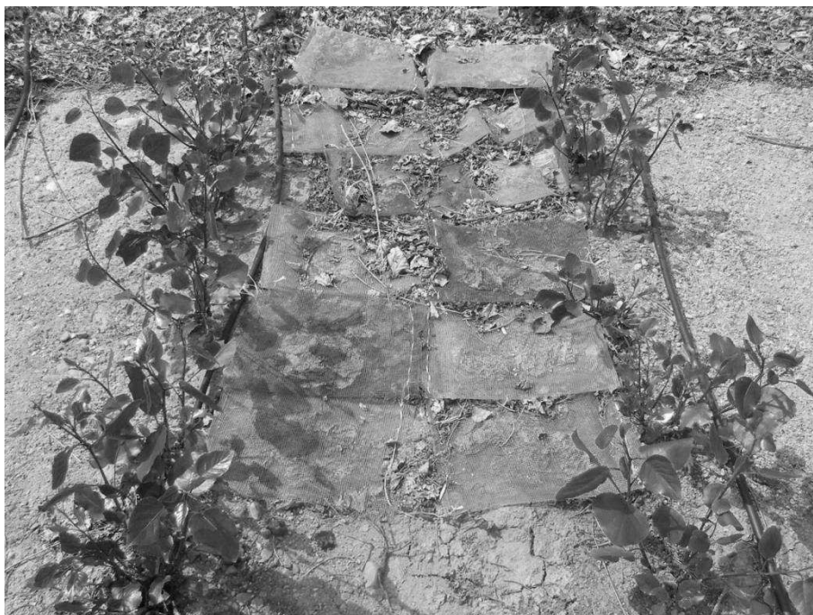
Foto 3.5: Bolsas de hojarasca, de 4 mm de luz de malla, colocadas en los ensayos
