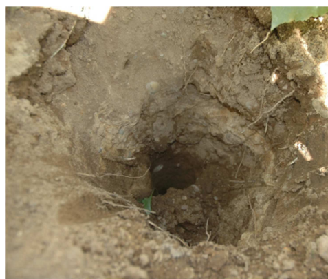
Foto 3.6: Calicata realizada para la toma de muestras de suelo a distintas profundidades
