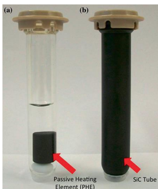
Figura 21: Elementos pasivos de calentamiento: a) fragmento de PHe, b) tubo de 10 ml (Fuente: De Souza, 2015)
