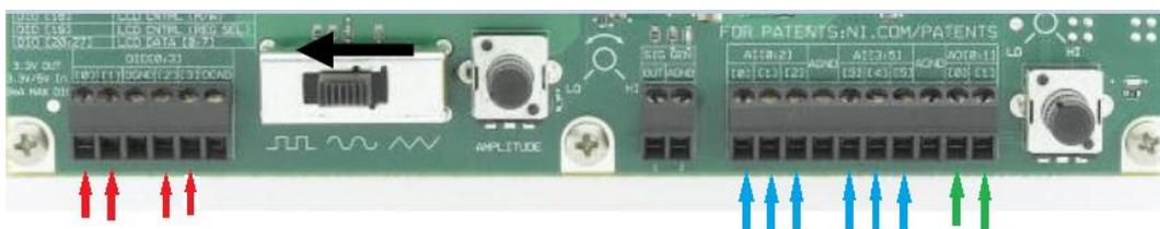
Figura 4.2. En rojo entradas ó salidas digitales, en azul entradas analógicas y en verde las salidas analógicas del sbRIO 9636.
