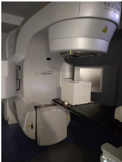
Figura 4.5: Imagen del acelerador lineal *Truebeam™*, durante la colocación de las películas para radiación.
