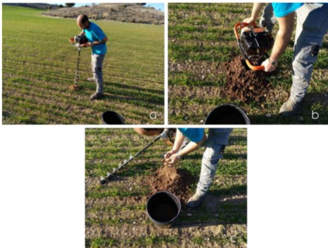
Imagen 3. Muestreo del suelo con motobarrenadora y preparación de muestra.
