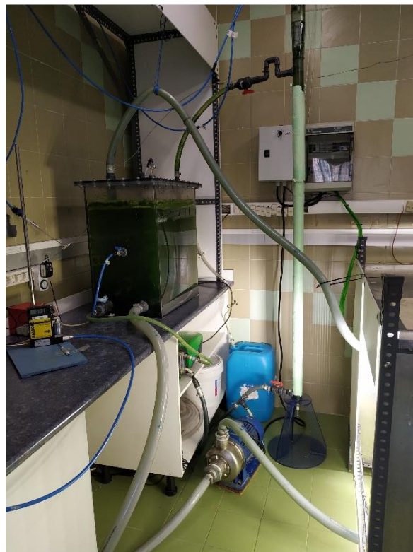
Imagen 8. Cámara de mezcla y columna de absorción del sistema experimental
