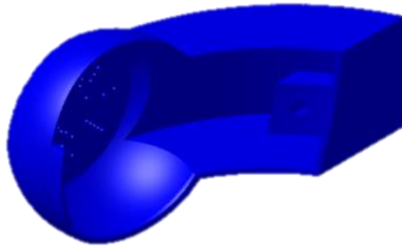
Figura 75. Modelo Catia V5 pieza orejera izquierda.
