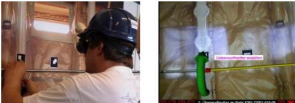
*Figura 11. Visualización con RA de sistema de agua Airbus*
