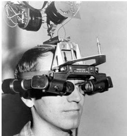
*Figura 2. "La espada de Damocles" considerada el primer sistema de pantalla montada en la cabeza (HMD) de Realidad Virtual*
