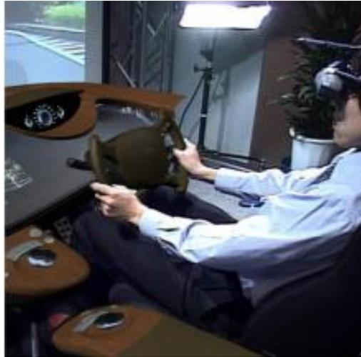
*Figura 9. Aplicación en la que el usuario puede interactuar con el coche físico y ver o modificar los acabados virtuales*
