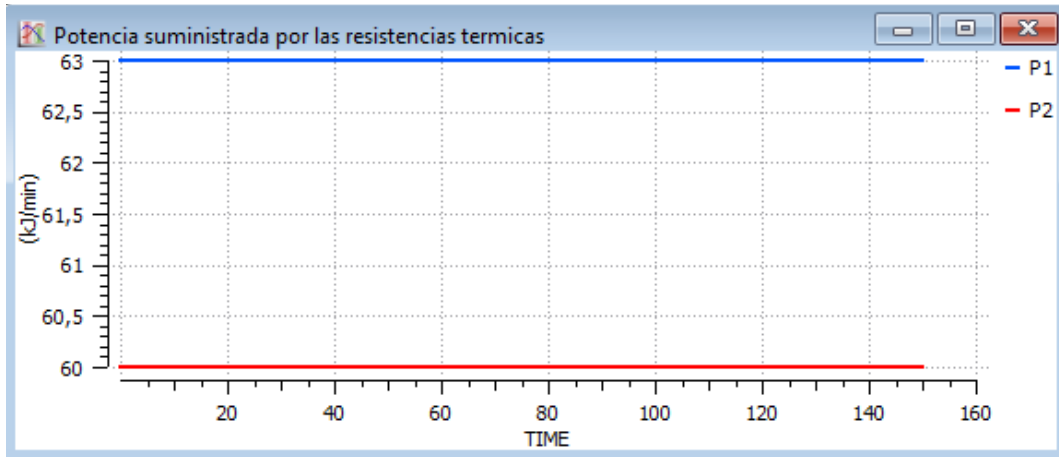
Figura 54 Potencia suministrada a las resistencias térmicas para calentar el agua de los depósitos que posteriormente fluirán por el serpentín (P1, P2).
