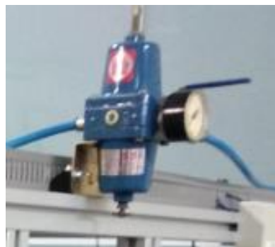
Figura 38 Válvula que aporta aire en unas condiciones determinadas a la válvula de control del caudal (F).
