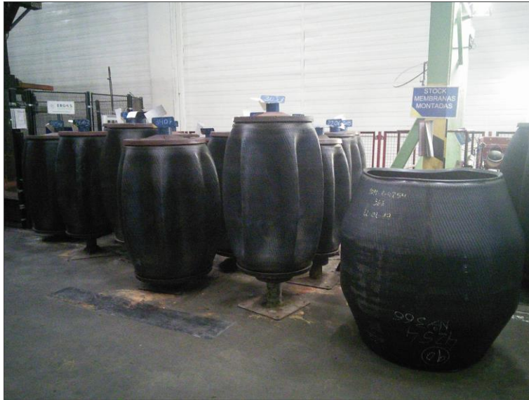
Figura 6 – Distintas membranas montadas en el taller de cocción (© Michelin).
