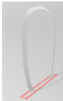
Figura 6.5- Forma de la ranura que se implementará en el casco para que la máscara se incruste en ella
