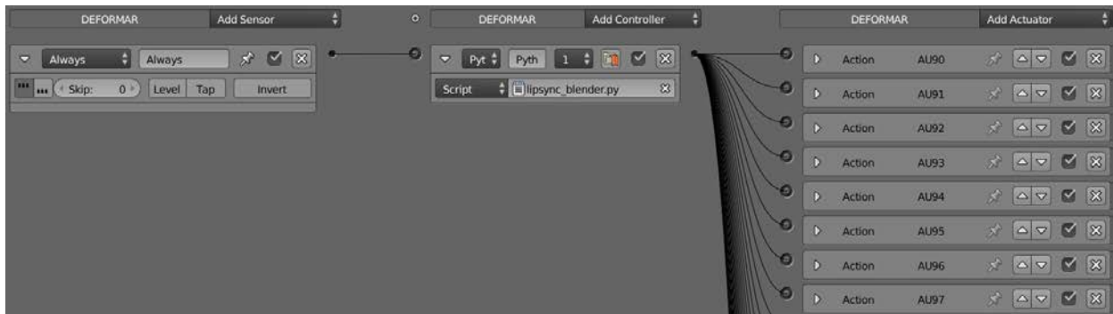
Figura 5.7- Configuración del editor lógico con el controlador y los actuadores empleados
