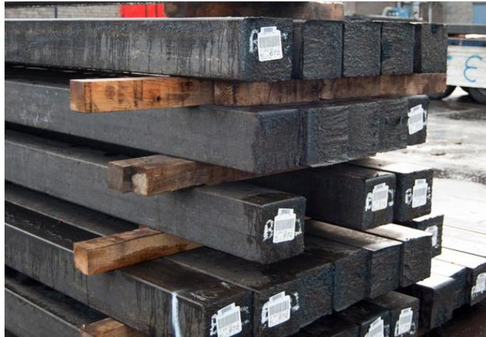
*Fig. 21 Palanquillas de acero*
