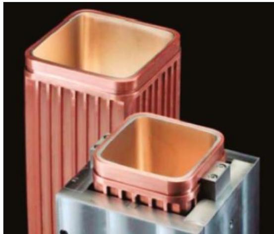
*Fig. 30 Molde tubular de cobre*
