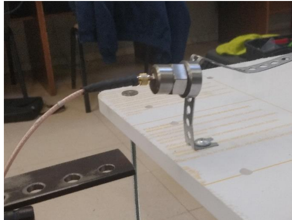
Figura 3.6: Detalle de la colocación del acelerómetro
