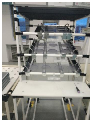
Figura 2.14 Suministro de bandejas vacías frente puesto P5
