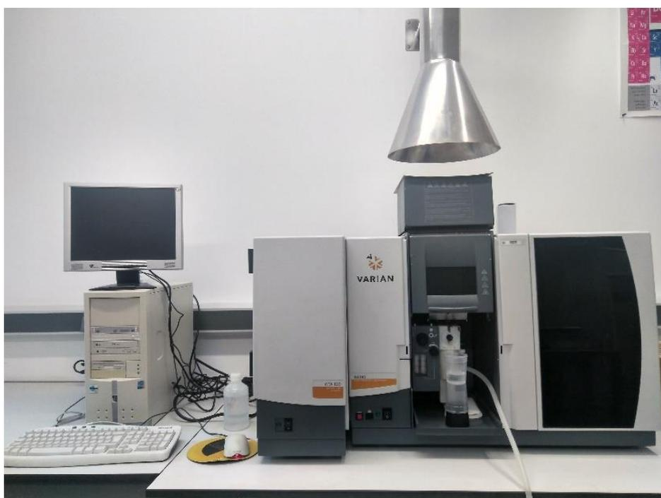
*Ilustración 9: Equipo de espectroscopía de absorción atómica*
