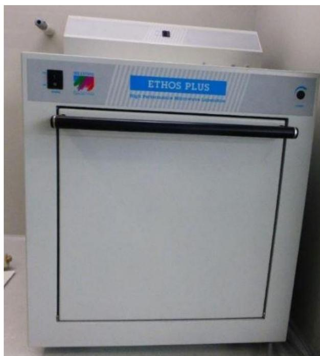
Ilustración 8: Horno microondas ETHOS PLUS MILESTONE
