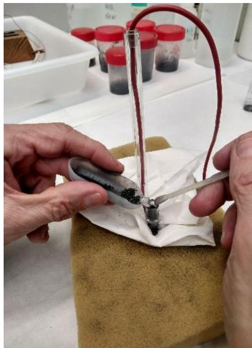
*Ilustración 13: Adición de la mezcla al electrodo*
