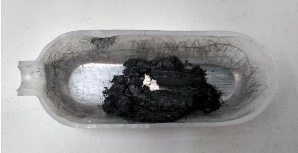
*Ilustración 10: Mezcla de carbono con muestra de sedimentos*
