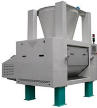
Figura 5: Prerrefinadora de dos cilindros
