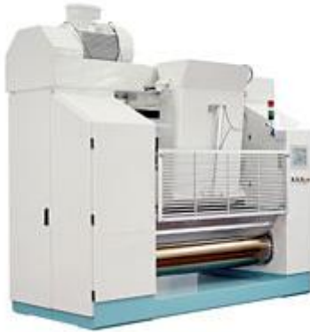
Figura 6: Refinadora de cinco cilindros
