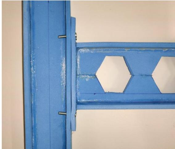
*Figura 2.12: Detalle Pilar-Dintel alma aligerada unión sin rigidizar*
