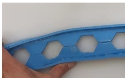
*Figura 4.3: Efectos locales en viga de alma aligerada*
