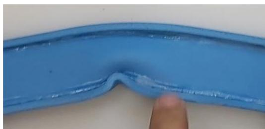
*Figura 4.2: Abolladura local en viga*
