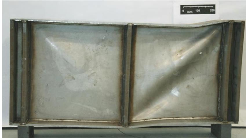
*Figura 1.4: Abolladura del alma [4]*
