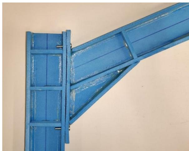
*Figura 2.16: Detalle Pórtico unión entre pilar y dintel*
