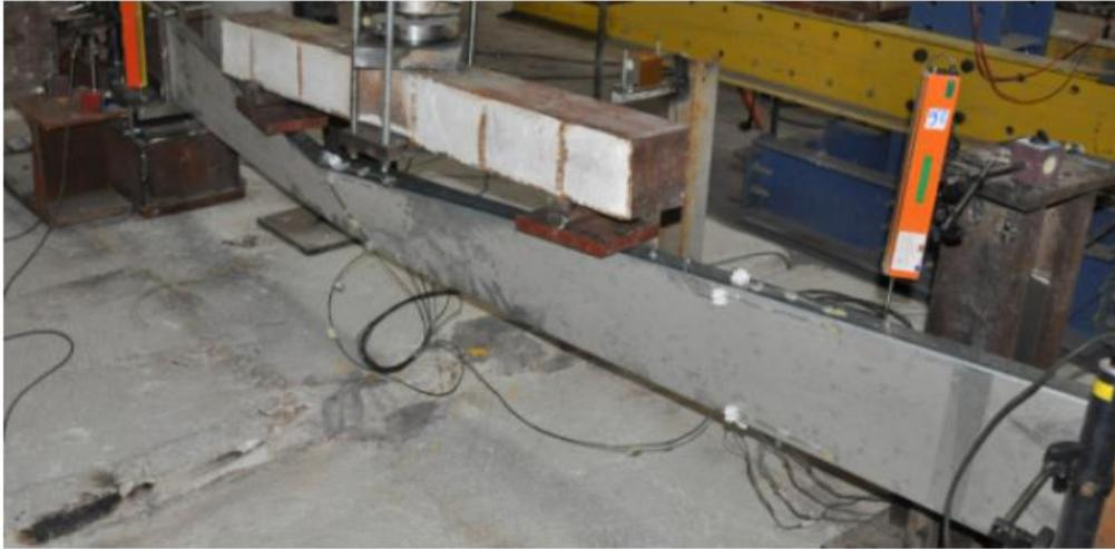
*Figura 1.2: Pandeo lateral viga doble T [3]*
