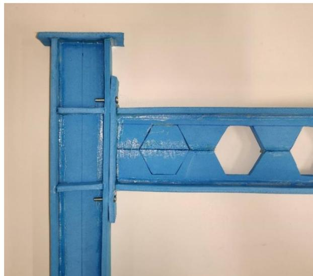
*Figura 2.11: Detalle Pilar-Dintel alma aligerada unión rigidizada*
