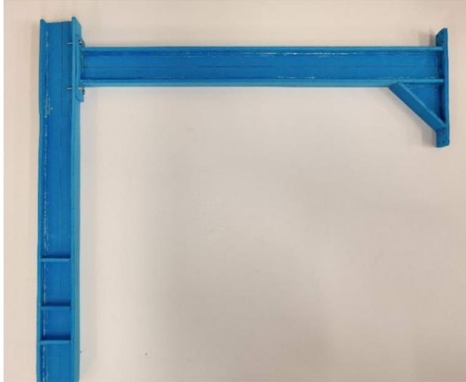
*Figura 2.6: Pilar-Dintel unión sin rigidizar*
