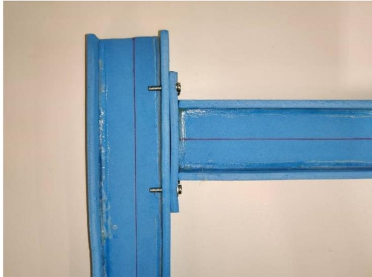
*Figura 2.8: Detalle Pilar-Dintel unión sin rigidizar*
