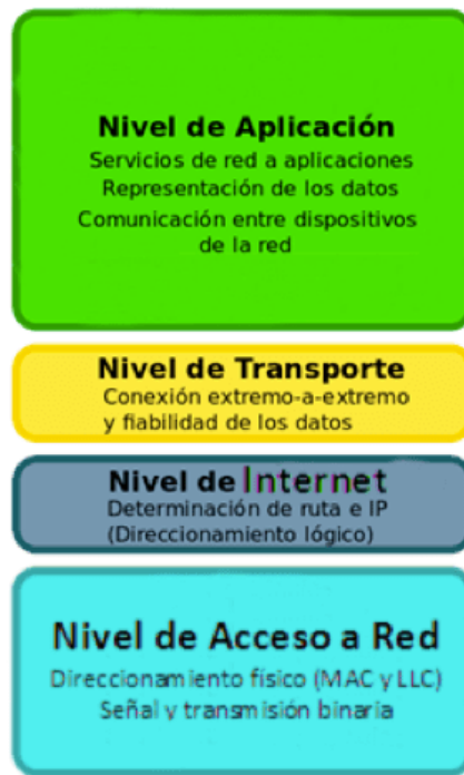
Figura 10 Estructura del modelo TCP/IP
