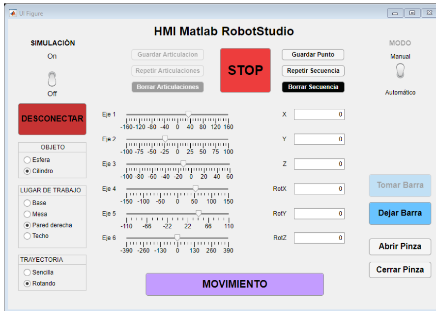
Figura 124 Barras deslizantes en modo manual
