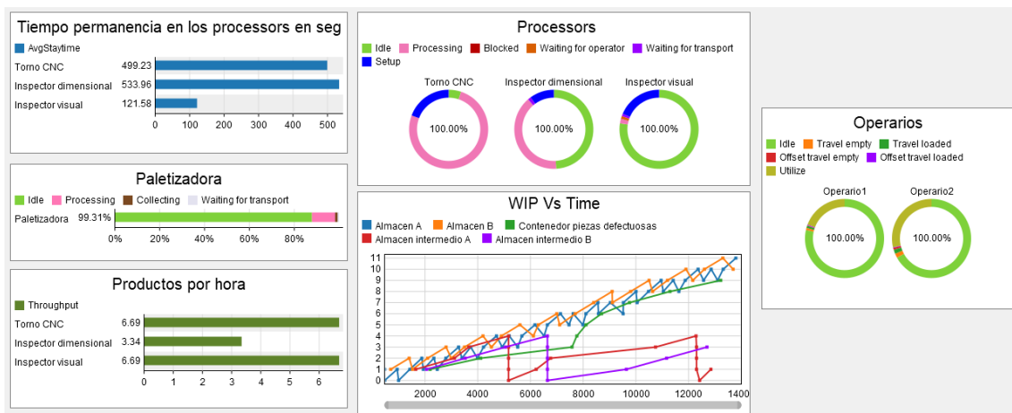
Ilustración 6.6. Dashboard del modelo célula en U con dos operarios en el instante 7 200
