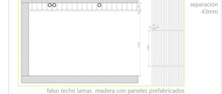
falso techo lamas - madera con paneles prefabricados
