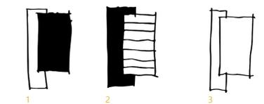
en la torre aparecen una serie de mecanismos similares empleados para la composición del cuerpo principal. primero, se propone un cuerpo principal en el que se desarrollarán los usos contenidos (1). segundo, se utiliza una estructura principal de hormigón armado a modo de fuste de la torre, que al mismo tiempo será contenedor de la comunicación vertical (2). por último, se propone una macla de ambos elementos, dando lugar al volumen final
