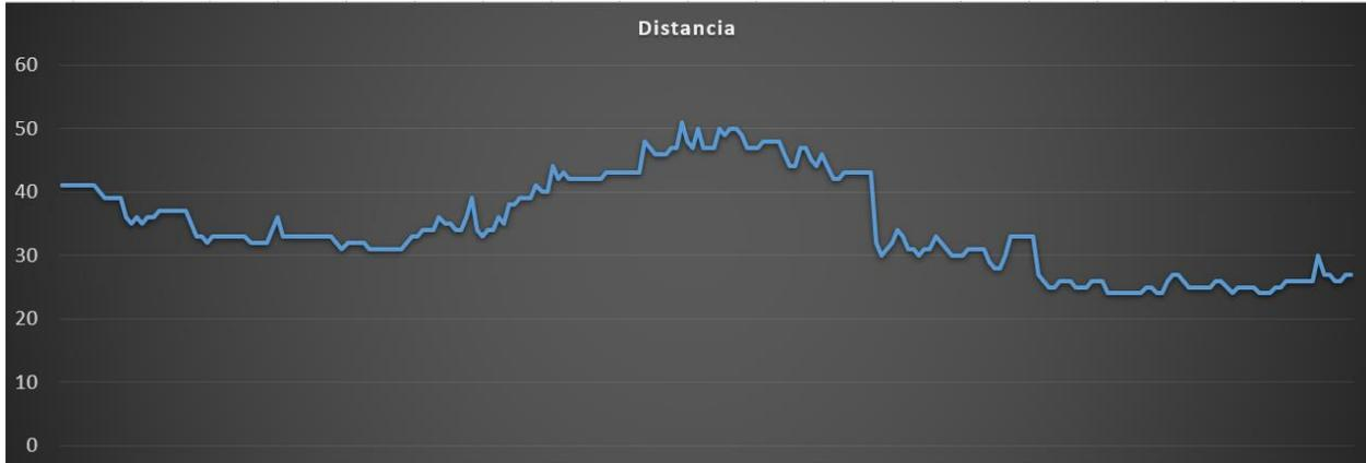
*Figura 3.10 Distancia medida con el sensor (eliminación de picos)*
