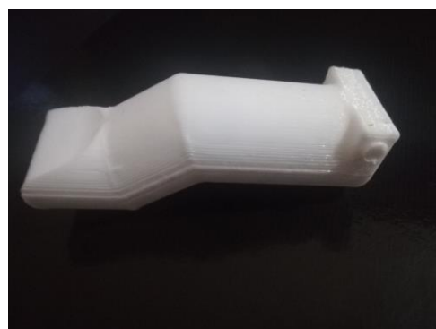
Imagen 48. Versión 2.0. Diseño del dedo. Impresión FDM (PLA)
