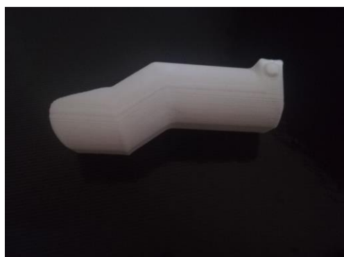
Imagen 48. Versión 2.0. Diseño del dedo. Impresión FDM (PLA)
