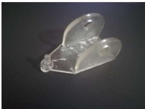
Imagen 56. Versión 3.0. Diseño del soporte. Impresión SLA (Clear)
