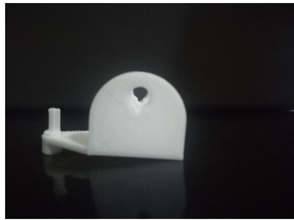
Imagen 55. Versión 3.0. Diseño del soporte. Impresión FDM (PLA)
