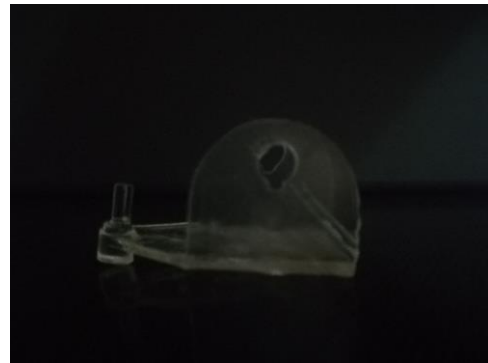
Imagen 56. Versión 3.0. Diseño del soporte. Impresión SLA (Clear)
