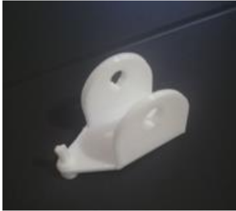
Imagen 55. Versión 3.0. Diseño del soporte. Impresión FDM (PLA)
