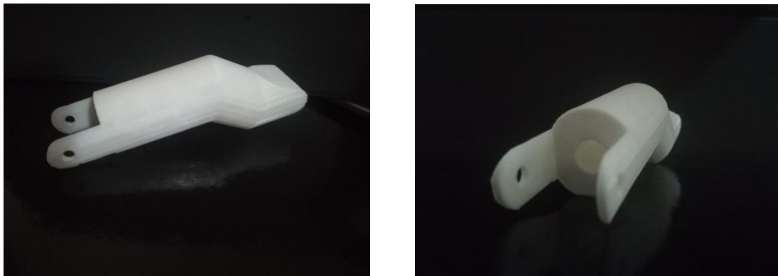
Imagen 50. Versión 3.0. Diseño del dedo. Impresión FDM (PLA)
