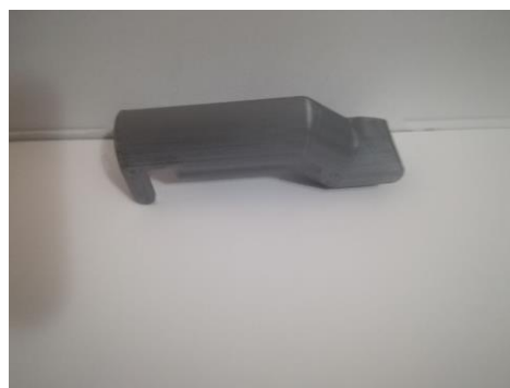
Imagen 46. Versión 1.0. Diseño del dedo. Impresión FDM (PLA)
