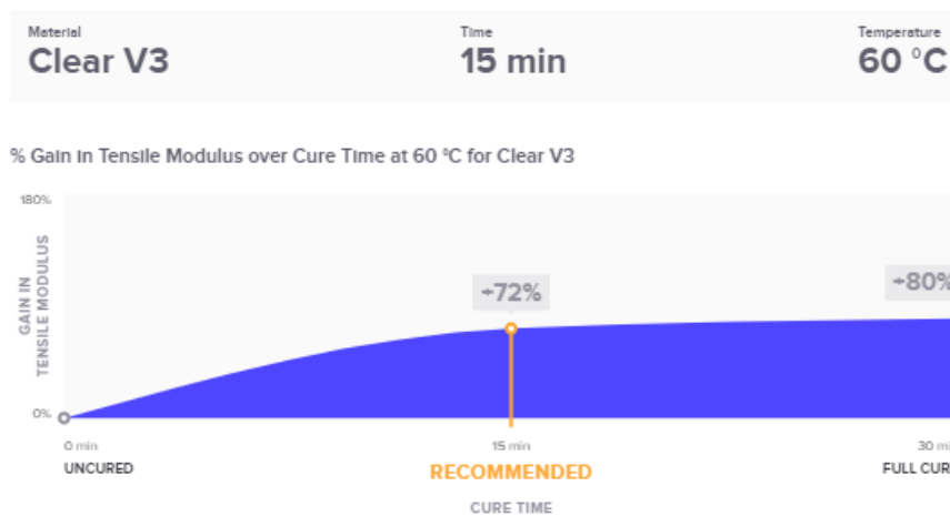
Imagen 42. Gráfica de curado de la resina tipo Clear.
