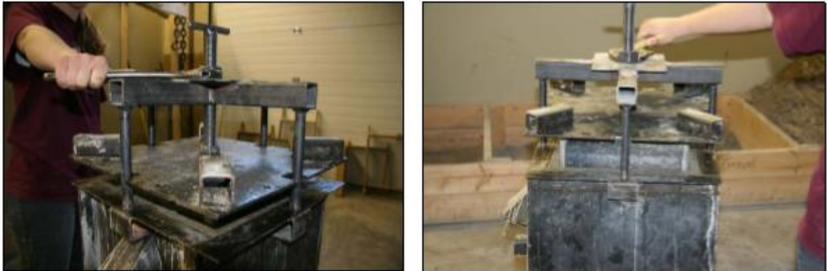
Figura 5. Ajuste del extractor durante la retirada del molde interior.
