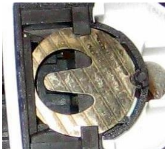
Figura 43. Pestaña del circuito de apagado de una tetera eléctrica [27]
