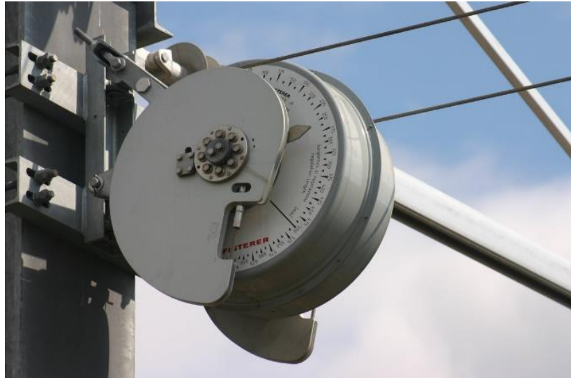
Figura 29. . Sistema de compensado compacto, formado por un resorte en espiral y una leva [20]
