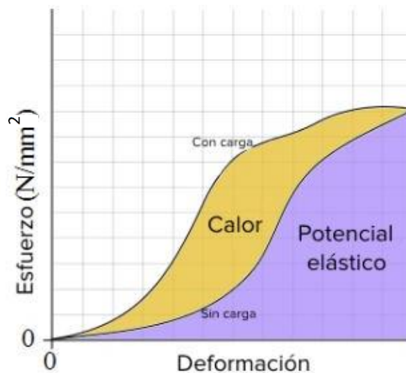
Figura 17. Fenómeno de histéresis en resortes sometido a flexión [11]
