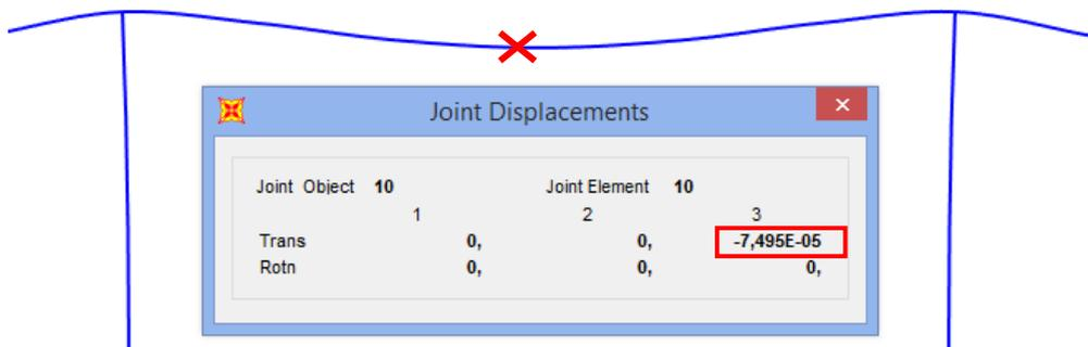
Imagen 102. Valor máximo del vano central de la deformada debida al peso propio del pórtico de la viga carril
