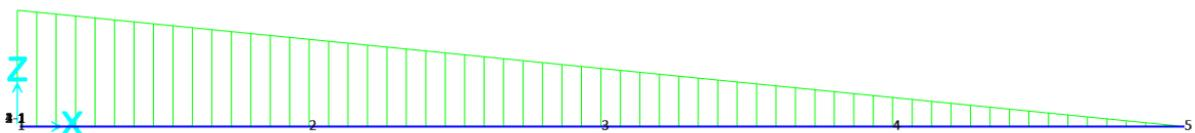
Imagen 50. Línea de influencia de la reacción del extremo izquierdo de la viga biapoyada
