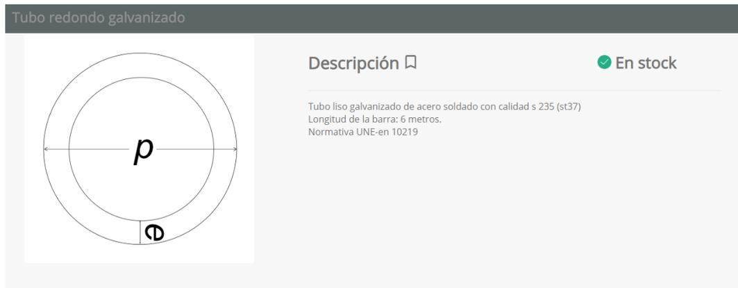
Ilustración 108. Tubos laminados de espesor 2 mm (<https://www.incafe2000.com/Esp/tubo-redondo-galvanizado>)
