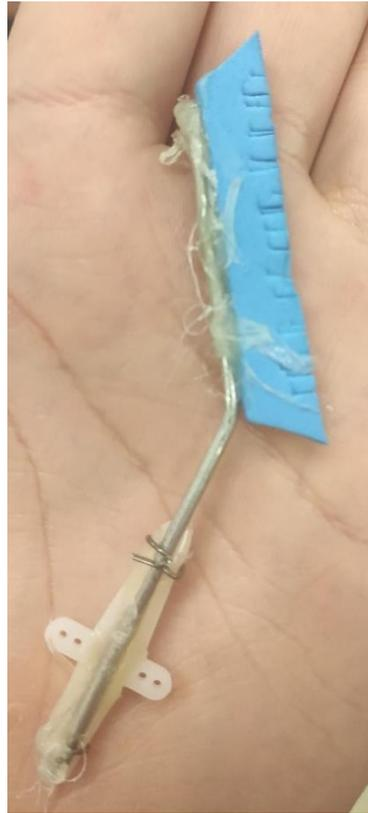
*Figura 3.37. Varilla del servo bloqueador del TMD, hecho con Goma-EVA.*
