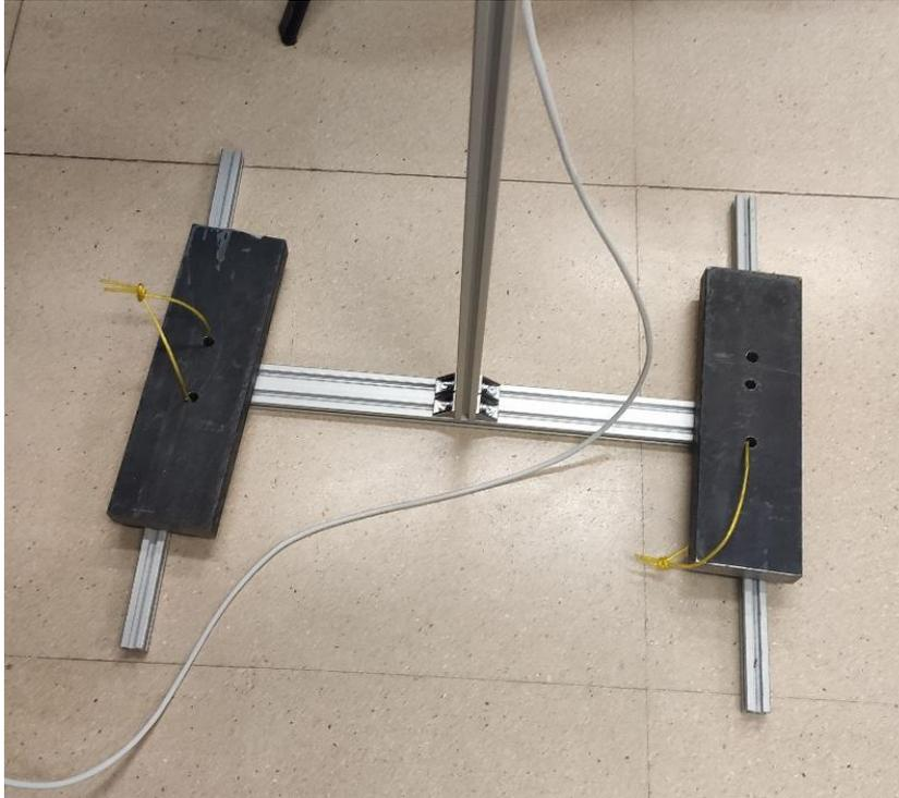
*Figura 2.5. Base de la estructura lastrada y unión de la base con la barra principal del trabajo.*
