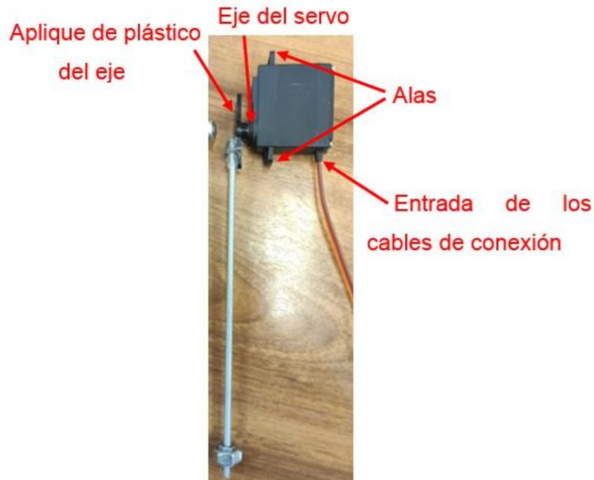
*Figura 3.28. Primer montaje del péndulo excitador de 0,15 m de longitud. Se indican las partes más importantes del servo.*
