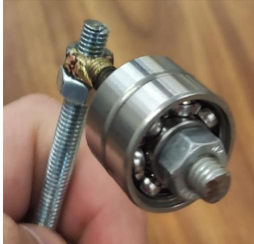
Figura 3.34. Detalle de los rodamientos y la unión entre las dos barras.
