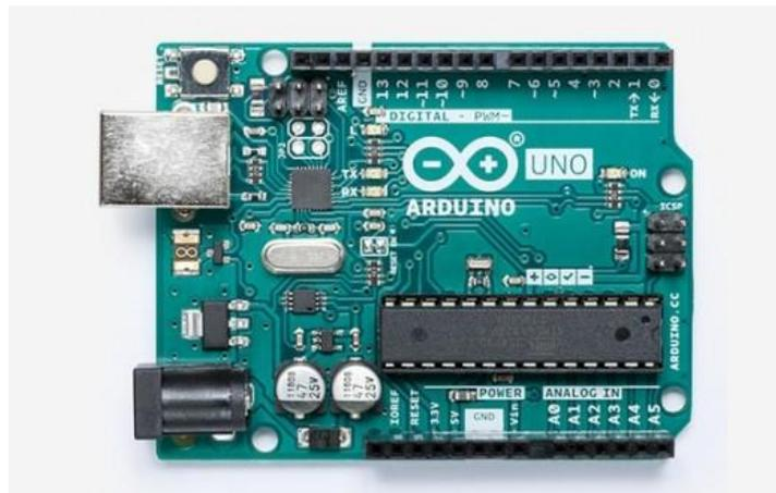
Figura 5.1. Placa Arduino UNO REV 3. [23]
