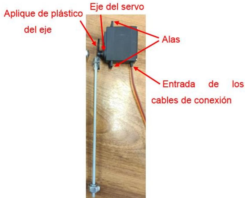
Figura 3.22. Servomotor MG995, en que pueden verse las alas y la conexión de los cables.
