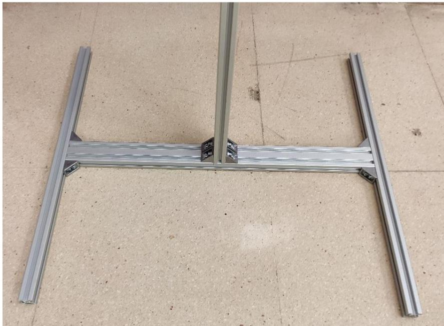
*Figura 2.4. Base de la estructura sin lastrar y unión entre las barras de la base y entre la base y la barra principal de la estructura.*
