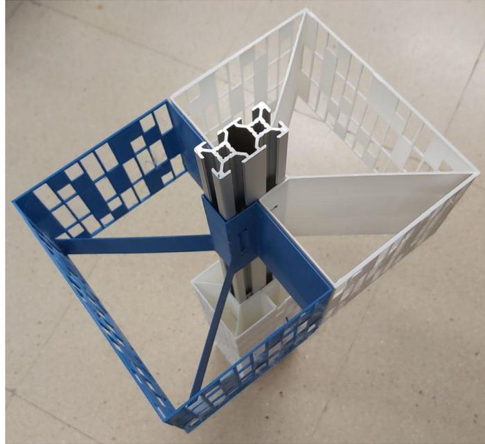
*Figura 2.16. El carenado de la izquierda es la 5ª y definitiva versión del carenado genérico. A la derecha 4ª versión del carenado genérico.*
