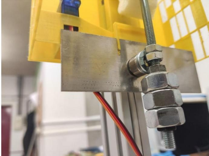
*Figura 3.36. Sistema de amortiguación de la maqueta montado sobre el carenado porta TMD.*
