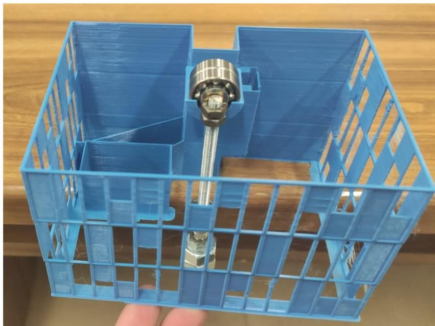
Figura 3.35. TMD definitivo inserto dentro de la 2ª versión impresa del carenado porta TMD.
