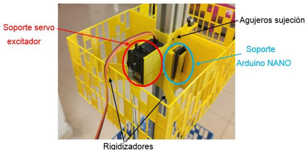
Figura 3.1. Impresión de la 3ª versión del carenado porta servo con sus elementos insertos. Se indican las partes más importantes del módulo.
