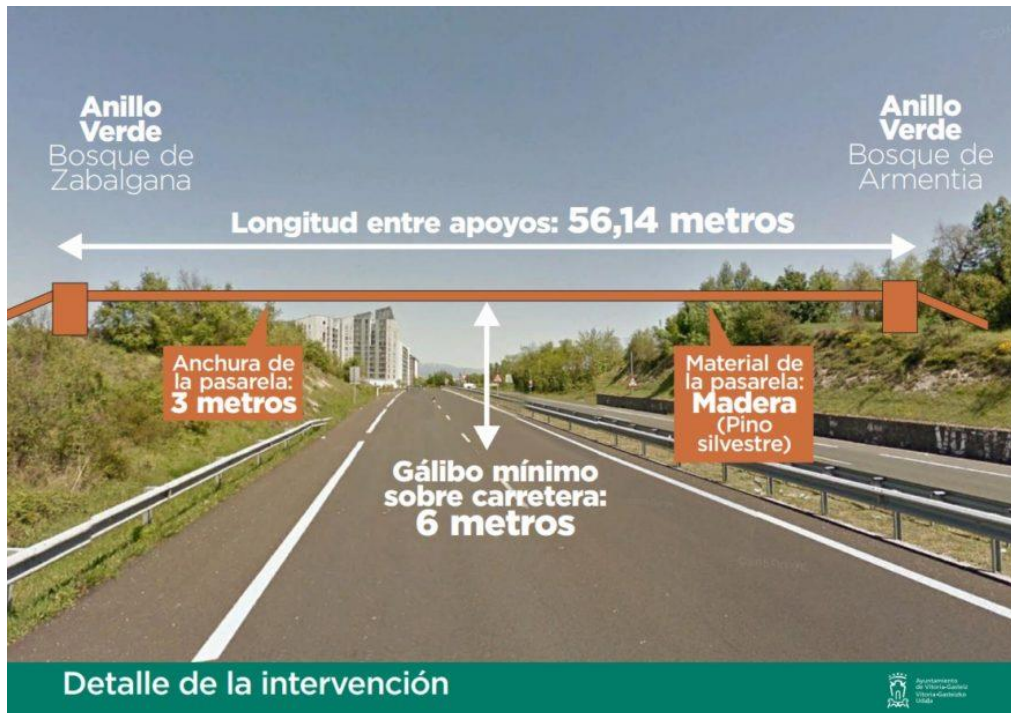
Ilustración 16. Dimensiones generales de la pasarela. [6]
