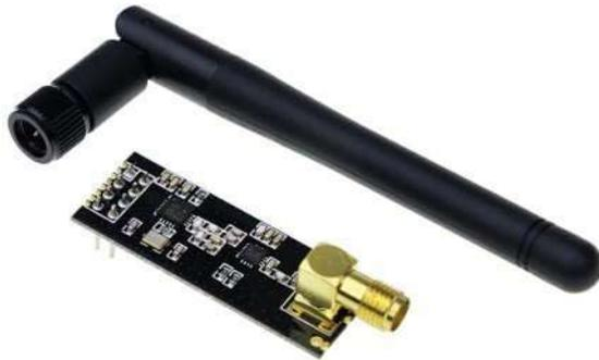
*Ilustración 19. Módulo 2.4 GHz NRF 24L01.*
