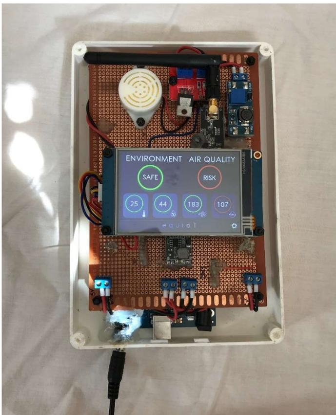
Ilustración 46. Módulo receptor encendido.
