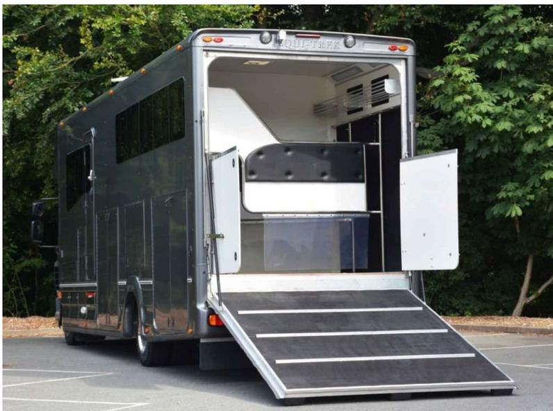
*Ilustración 5. Rampa de acceso posterior.*
