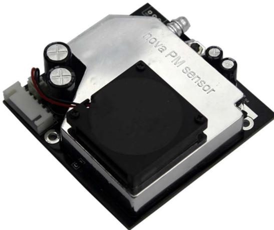
*Ilustración 22. Sensor Micropartículas SDS011.*
