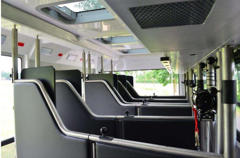
Ilustración 4. Particiones para el transporte equino.
