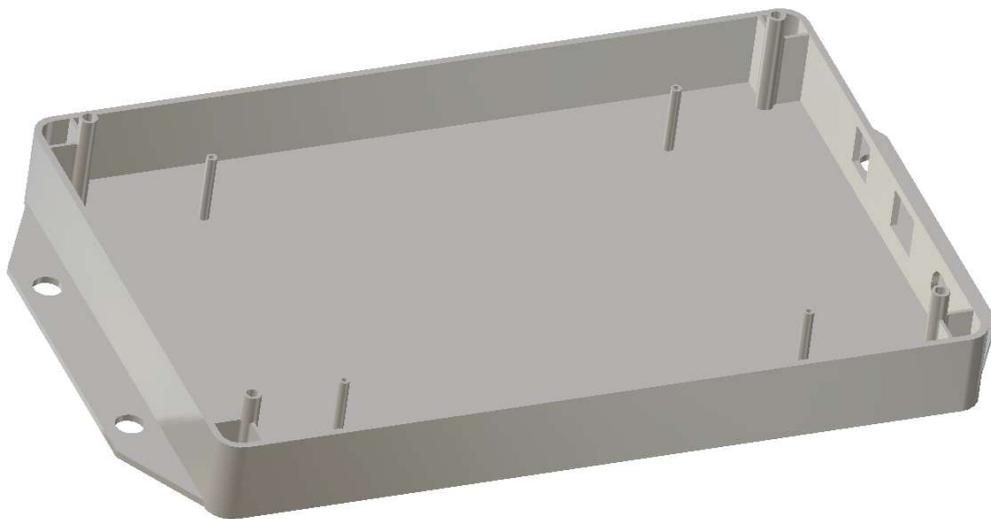
*Ilustración 29. Rediseño de Carcasa Inferior.*
