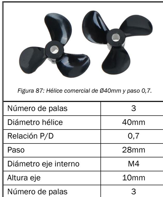
Se compran dos hélices del mismo modelo, pero con el sentido de giro inverso, siendo las estelas del agua simétricas respecto del plano de crujía del casco. De esta manera, se compensan mucho mejor las estelas de agua que generen ambas hélices, evitando problemas de direccionado o giros por el efecto del giro en el mismo sentido.
