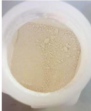
FIGURA 6: ASPECTO DE LA ZEOLITA TIPO BETA EMPLEADA
