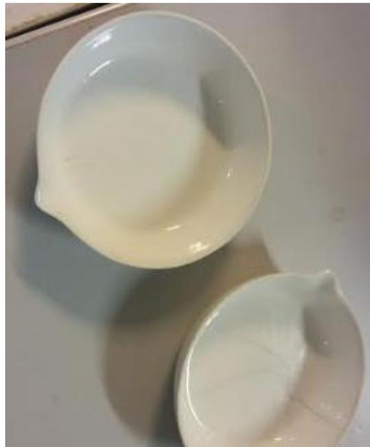
FIGURA 9: CRISOLES EMPLEADOS PARA CALCINAR LAS ZEOLITAS
