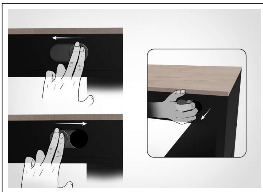
Fig 127. Forma de proceder a la apertura y cierre de la tapa trasera
