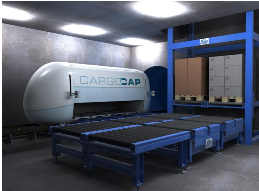
Figura 3-12 Capsulas con transportadores de carga horizontal (Cargocap)
