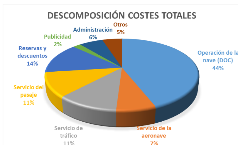
Ilustración 27 Descomposición costes totales de operación de un vuelo. Elaboración propia a partir de (ICAO, 2017).
