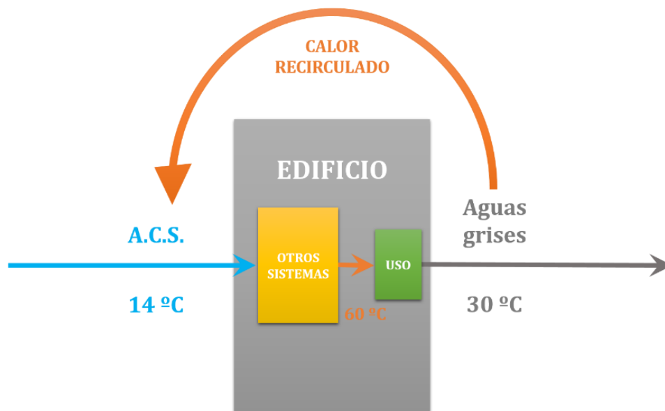
Figura 2.1. Esquema de la recirculación del calor residual de las aguas grises en un edificio.
