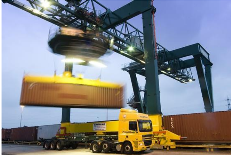
Figura 17: Grúa apiladora Fuente: Página web "Liebherr"
