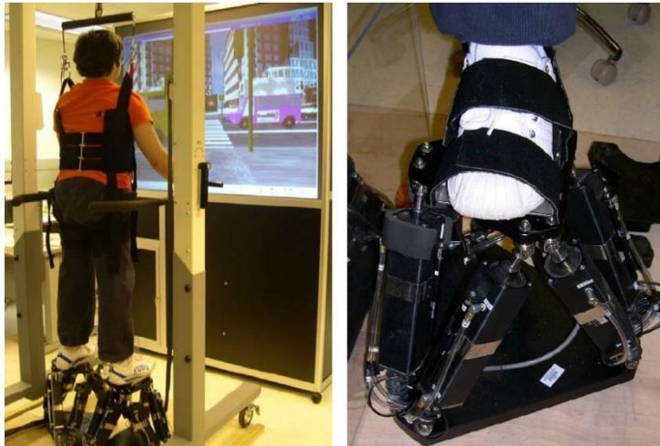
Figura 20. Prototipo de simulador de movilidad con plataformas Rutgers Mega Ankle Stewart
