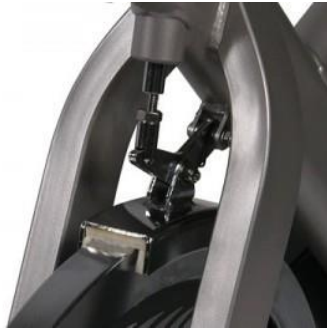
Figura 12. Sistema de frenado de bicicleta estática por fricción
