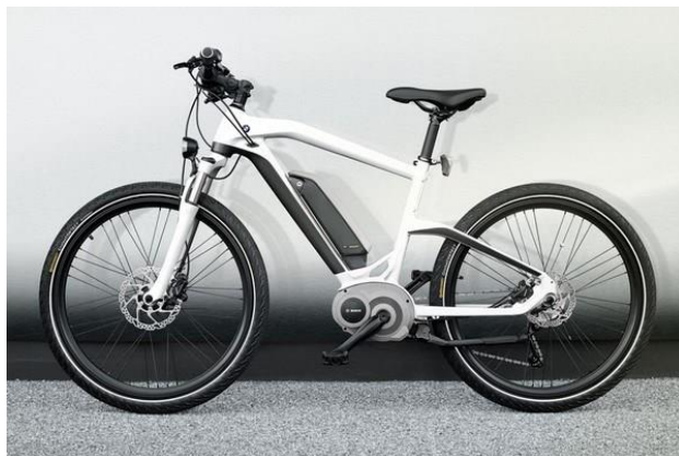
Figura 10. Bicicleta eléctrica de montaña con motor en el eje del pedaliar
