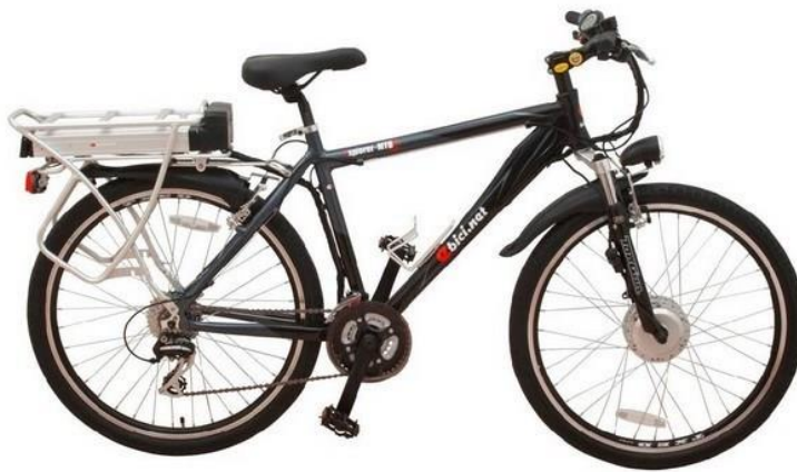
Figura 8. Bicicleta con motor en el buje de la rueda delantera
