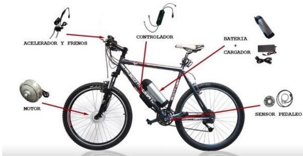
Figura 6. Bicicleta eléctrica de montaña con motor en el buje de la rueda delantera
