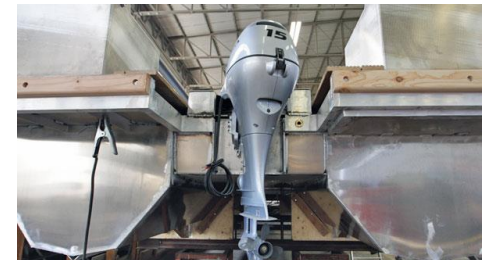
FIG.80_ Motor fuera borda tipo FIG.81_ Motor fuera borda instalado en la plataforma de flotación
