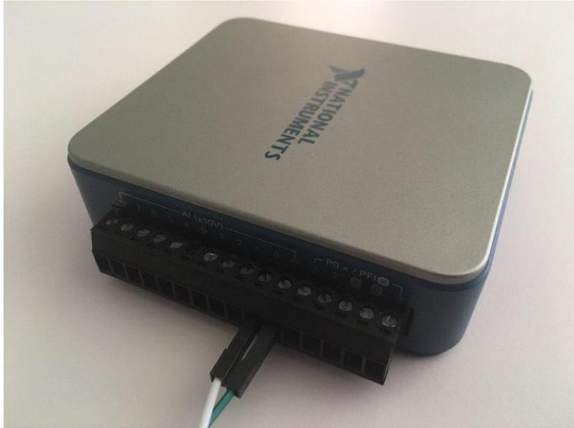
Figura 33.- Tarjeta lectora NI USB-6000
