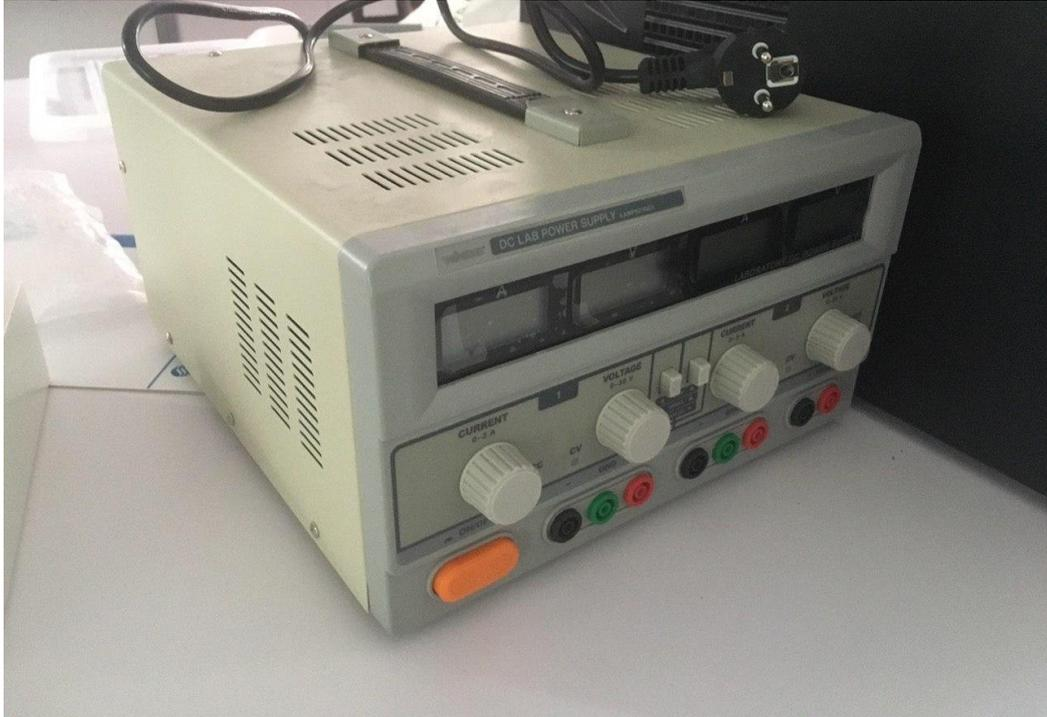
Figura 35.- Fuente de alimentación Velleman LABPS23023.
