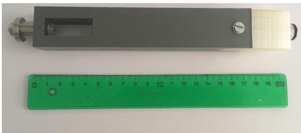
Figura 32. - Acople y pulsador solidarios a la máquina de ensayos.
