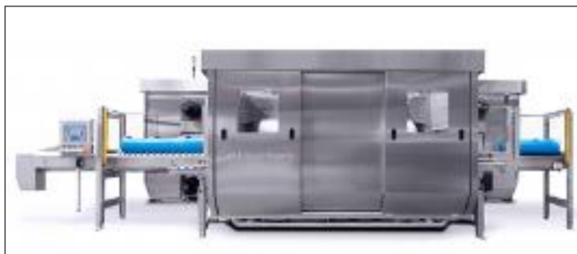
Figura 5. Máquina de altas presiones hidrostáticas Hiperbaric 135 L.
